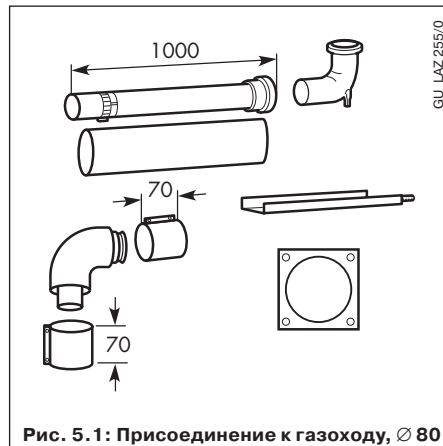
Рис. 5.1: Присоединение к газоходу, Ø80
