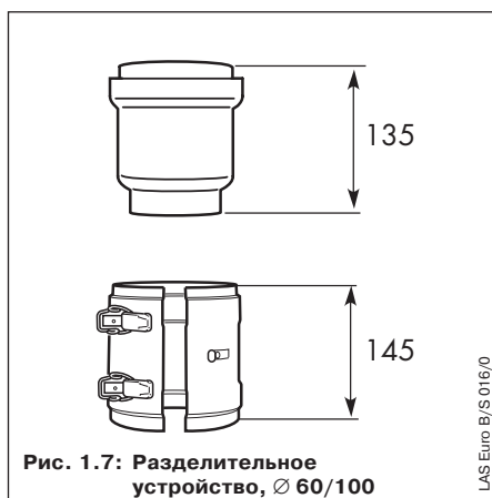
Рис. 1.6: Трубный хомут, Ø 100
